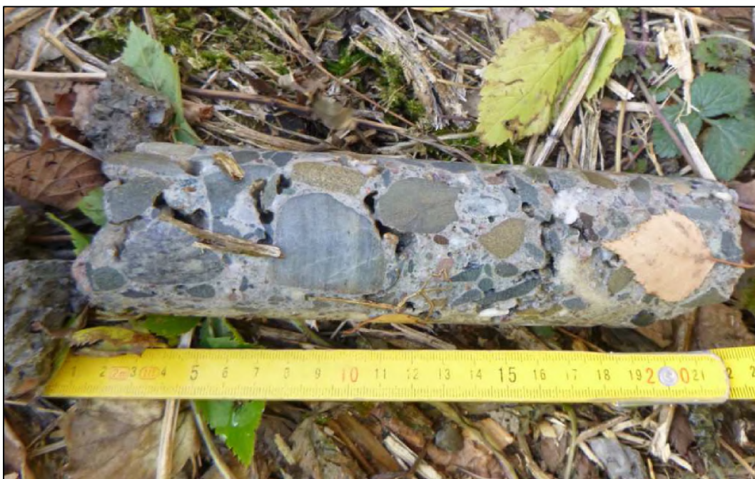
Obrázek 24 – TRHLINA T1, výnos z vrtu T1
