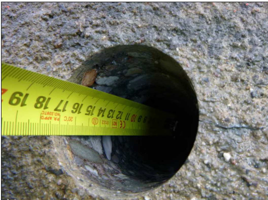
Obrázek 31 – pohled do vrtu T3, hloubka trhliny 175 mm
