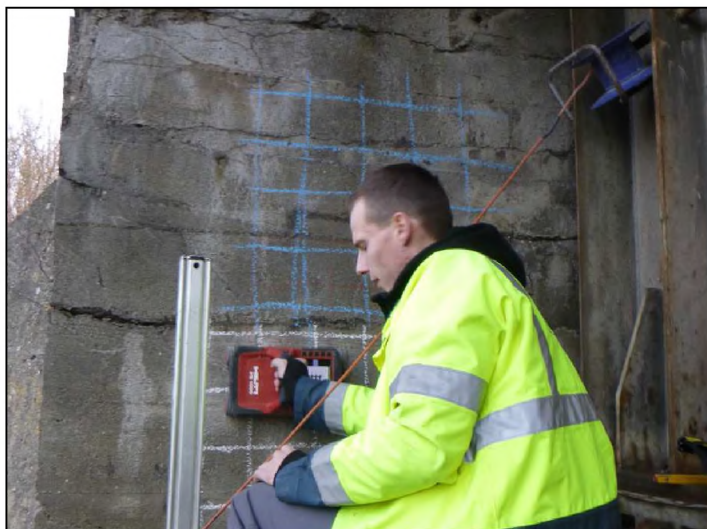
Obrázek 9 – provádění plošného skenování přístrojem HILTI
