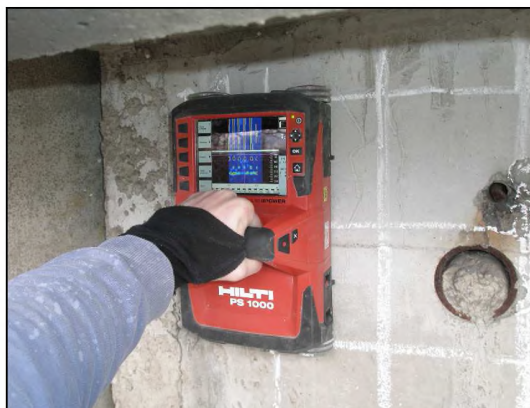
Obrázek 8 – RADAR HILTI PS1000 01X Concrete Pulse Radar.
