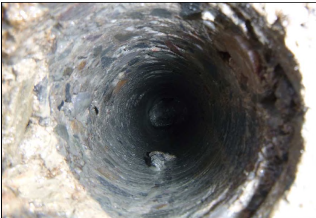
Obrázek 33 – TRHLINA T4 – pohled do vrtu
