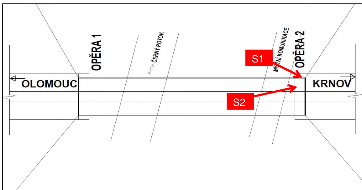
Obrázek 16 – schéma umístění míst destruktivní diagnostiky na opěře O 01
